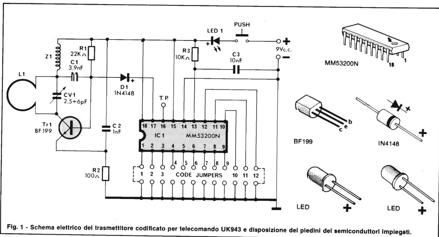
Fig. 1 - Schema elettrico del trasmettitore codificato per telecomando UK943 e disposizione dei piedini dei semiconduttori impiegati.
